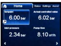
A comunicação com a bomba auxiliar é possível através do painel de controlo da bomba ou ao utilizar a Grundfos GO e à distância por meio de um sistema de gestão descentralizada.
