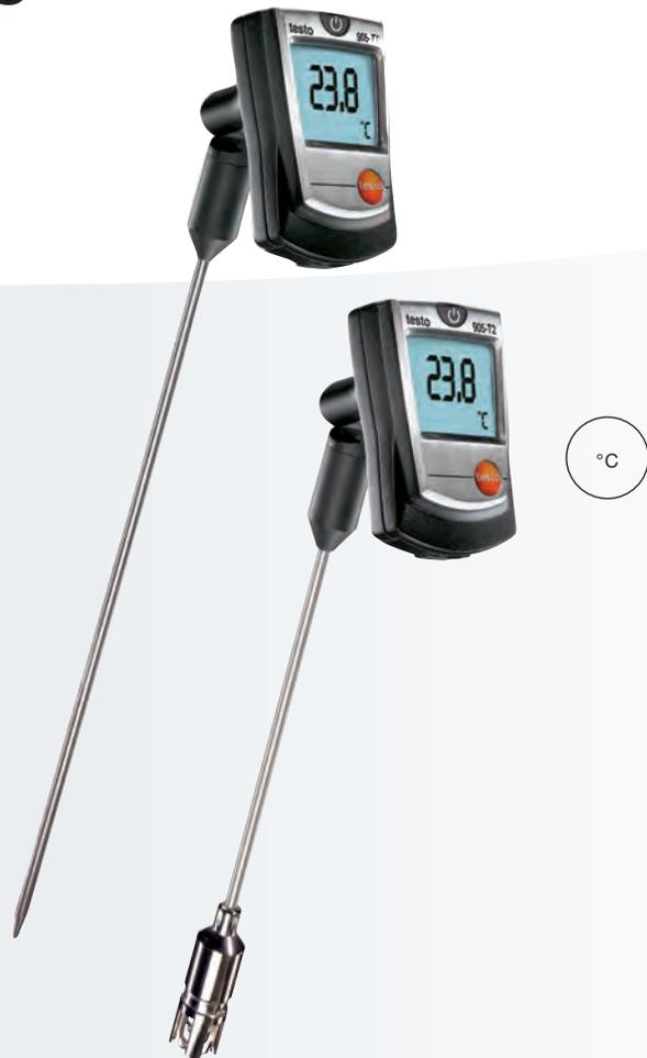
El testo 905-T1 es un termómetro de penetración particularmente rápido dentro de su rango de medición entre -50 y +350 °C, aunque brevemente también puede medir hasta +500 °C (entre 1 y 2 minutos). El instrumento está equipado con un sensor profesional industrial (termopar tipo K) que le confiere un excelente nivel de precisión, especialmente en la zona alta del rango de medición.
