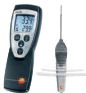
Medición sin cables con sondas por radio
