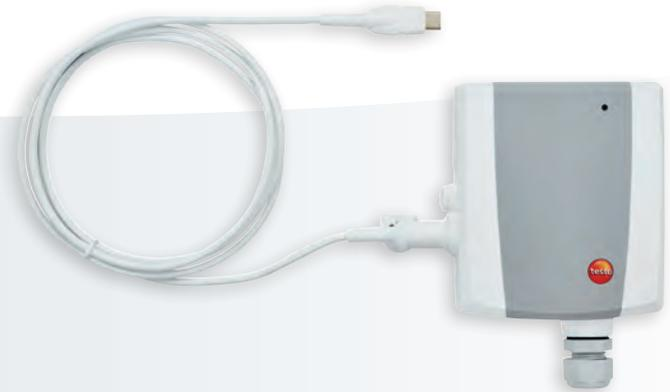
El acoplador analógico digital permite integrar otros parámetros de medición además de la temperatura, la humedad y la presión diferencial en el sistema de monitorización de datos de medición testo Saveris. De este modo es posible integrar todos los transmisores con interfaces estandarizadas de corriente/tensión.
