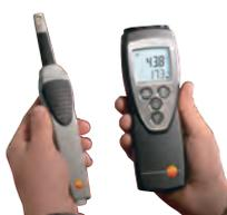
testo 625 con empuñadura por radio y módulo por radio
