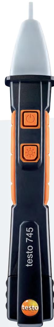
El detector de tensión sin contacto testo 745 con rango de medición de tensión de hasta 1000 V está especialmente indicado para una primera comprobación inicial de un posible error. Cuando se detecta tensión, el testo 745 avisa mediante una clara señal visual y acústica.
