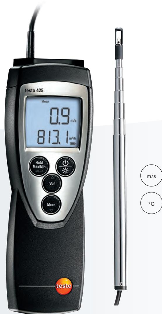
El testo 425 es un termoanemómetro compacto provisto con una sonda de velocidad térmica, con un cabezal de 7,5 mm de diámetro. La empuñadura es telescópica hasta 820 mm para poder medir con comodidad en conductos. El testo 425 mide de forma extremadamente precisa en el rango de velocidades más bajas. En el visualizador se muestra directamente el caudal, calculado introduciendo el área en el instrumento.
