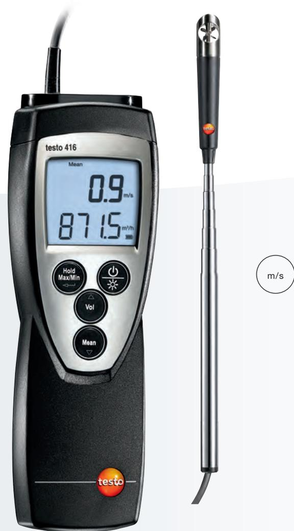
El testo 416 es un anemómetro compacto provisto de una sonda de molinete de 16 mm de diámetro conectada por cable fijo. La empuñadura telescópica de la sonda se extiende hasta los 890 mm, por lo que este instrumento es ideal para medir la velocidad en conductos.
