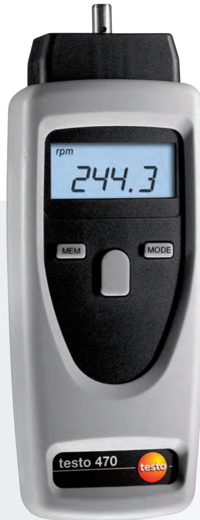
El ergonómico tacómetro testo 470 está equipado con los elementos idóneos para la medición óptica o mecánica de rpm. Con el adaptador y la sonda de medición o el disco de velocidad se convierte el tacómetro óptico en un tacómetro mecánico, con el que se miden fácilmente velocidades o longitudes. Para medir ópticamente, tan solo hay que pegar
