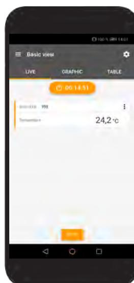
Con la App testo Smart gratuita, su smartphone se convierte en la pantalla del testo 915i. Tanto el manejo del Smart Probe como también la visualización de los valores medidos se llevan a cabo de forma inalámbrica por Bluetooth® en su smartphone, independientemente del lugar de medición. Además puede crear protocolos de medición en la App, añadirles fotos y comentarios y enviarlos cómodamente por correo electrónico.
