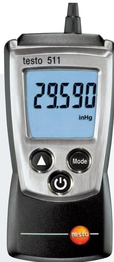
El testo 511 mide presión absoluta con una precisión hasta  $\pm 3$  hPa, ideal para la compensación de la presión absoluta durante las mediciones de velocidad en combinación con un tubo Pitot, por ejemplo. Introduciendo en el instrumento el valor de altitud sobre el nivel del mar, mide la presión barométrica. Además, también puede medir la presión barométrica entre dos puntos. El instrumento dispone de 8 unidades de presión seleccionables.
