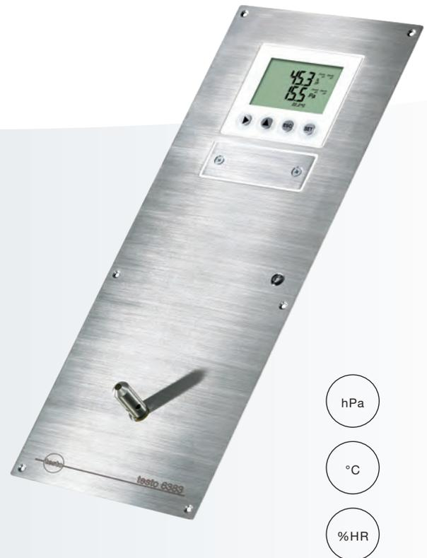
El testo 6383 es el transmisor de presión diferencial ideal para la monitorización de esta variable en el rango de 10 Pa a 10 hPa. En las aplicaciones en salas blancas, el mantenimiento de la presión positiva previene el ingreso de aire contaminado en las zonas críticas. Gracias a la sonda interna o externa opcional de la gama testo 6610 también se registran con un solo instrumento los valores de humedad y temperatura.
