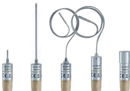
**Los registradores de datos CFR** están disponibles en cuatro modelos para temperatura y presión. Además se destacan por su robustez, durabilidad y fiabilidad. El cambio de pilas puede realizarse sin necesidad de herramientas y en pocos segundos debido a la rosca. Gracias a la construcción herméticamente estanca del registrador, este permanece 100 % estanco luego del cambio de pilas.
