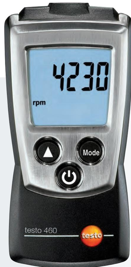
El testo 460 es un tacómetro con un tamaño reducido pero unas prestaciones enormes: mide las rpm ópticamente, p.ej. en palas de ventiladores o ejes, a una distancia óptima al objeto entre 10 y 40 cm. Para una buena medición tan solo hay que adherir un reflectante (opcional) al objeto, apuntar el indicador a la superficie reflectante y medir. Los valores mín./máx. se muestran directamente al pulsar una tecla.
