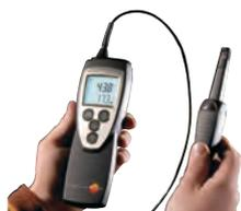
Sonda de humedad con empuñadura y cable
