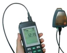
Inspección de transmisores con interface de 4 a 20 mA
