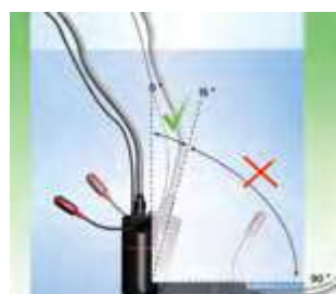
Versão SB: Instalação vertical ou ligeiramente inclinada - Não se pode instalar horizontalmente.
