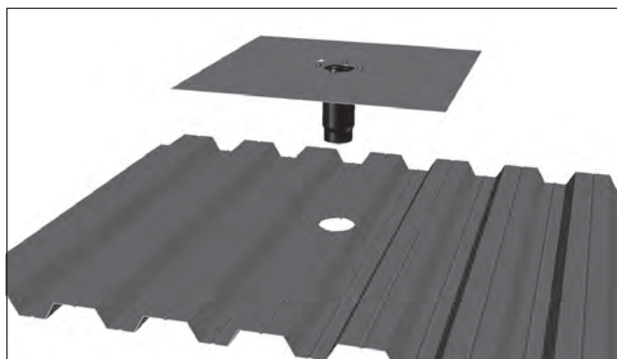
Imagen 1.4: Chapa de refuerzo con conexión para barrera de vapor
