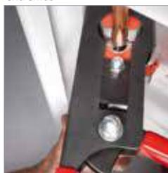
Parada de profundidad automática. Posicionamiento perfecto del tubo en el cono del reborde
