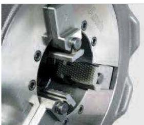
Cabezas automáticas con ajuste rápido del tamaño de la rosca, longitud de rosca automática, profundidad de rosca finamente ajustable sin recentrado
