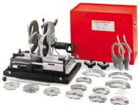
Máquina básica con desbastadora eléctrica, soporte para placa de calentamiento, placa de calentamiento con ajuste electrónico, conjunto de fijación básico Ø 160 mm y 250 mm piezas de soporte de Ø 160 mm y 250 mm, reductores y piezas de soporte desde Ø 40 - 140 mm y Ø 180 - 225 mm, herramientas de instalación, caja de transporte de acero 800 x 520 x 765 mm (LxWxH) y maletín de transporte de acero para piezas reductoras y de soporte
