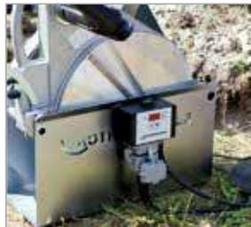
Unidad hidráulica con manómetro grande, fácilmente legible, así como una limitación de presión y válvula de alivio de presión.
