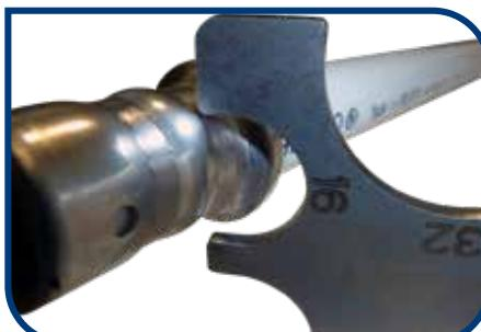
3. Posicione o recorte correspondente da ferramenta de medição na secção pretendida da alma de cravamento pressionada.
