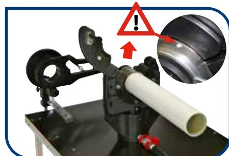
Coloque o acessório Não mordente e certifique-se a guia de cravamento do acessório fica localizada Não componente de posicionamento de alumínio. Seguidamente insira o tubo completamente Não acessório de press até que a cor do tubo seja visível nas janelas de inspeção. Agora o acessório pode ser pressionado ativando a bomba hidráulica.
