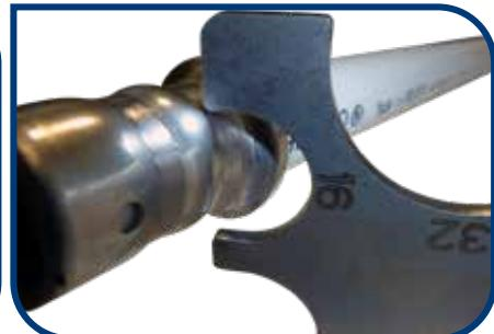
3. Posicione o recorte correspondente da ferramenta de medição na secção pretendida na alma de cravamento pressionada.
