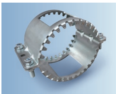
Abraçadeiras rápida FP PREIS® Para fixar juntas de tubos com cargas de pressão interna superiores a 0,5 bars
