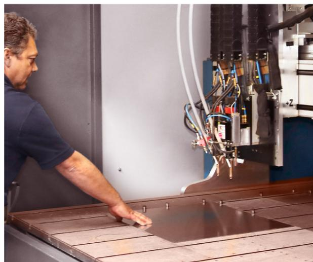
Assim nascem as unidades DUO, usando chapas de aço com um design especial, que servirão de suporte para os diferentes elementos que compõem as unidades de Comfort Port DUO
