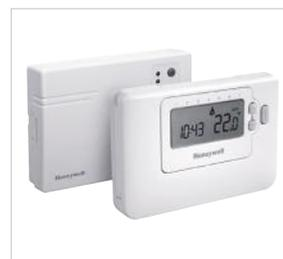
**Cronotermostato via rádio CM 727RF** - Cronotermostato semanal, controlo proporcional+integral; campo regulação: 5°C - 30°C; contacto inversor unipolar; Alimentação: 24V ~ 220V - 50Hz; 4 níveis de temperatura; alimentação por pilhas; controle via rádio; frequência 868MHz; Ligação à caldeira A e B.
