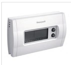
**Cronotermostato semanal Honeywell** - Controlo proporcional + integral, campo regulação: 5°C - 30°C, contacto inversor unipolar, Alimentação: 24V ~ 220V - 50Hz, 4 níveis de temperatura, alimentação por pilhas(incluídas), controle a dois fios, Ligação à caldeira A e B.
