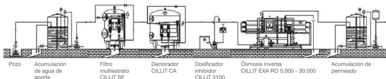
Pozo      Acumulación de agua de aporte      Filtro multiestrato CILLIT SF      Decolorador CILLIT CA      Dosificador inhibidor CILLIT 3100      Ósmosis inversa CILLIT EXA RO 5.000 - 30.000      Acumulación de permeado
