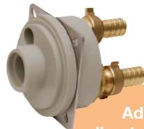
Adaptador universal para la conexión directa de la bomba de lavado del SoluTECH Easyflow al cuerpo de la bomba del circuito o caldera. Sin necesidad de desmontar por completo la bomba circuladora del circuito o caldera.
