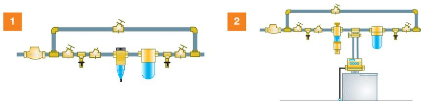
1 - Esquema de instalación filtro de seguridad con dosificador Cillit Immuno
