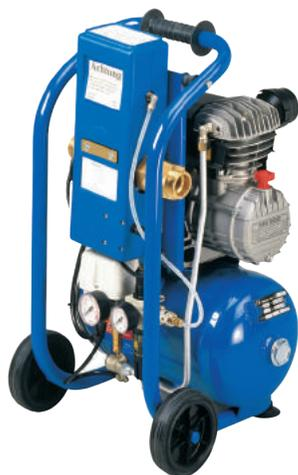
Equipo para la eliminación de las incrustaciones y las partículas depositadas en las tuberías de agua, según la Norma DIN 1988.
