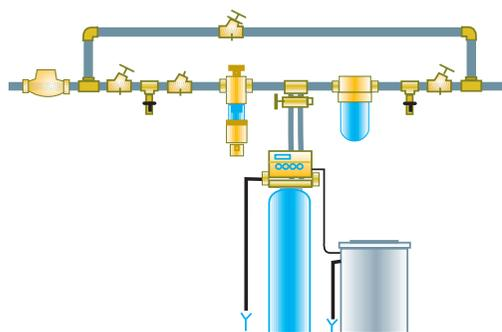
Esquema de instalación correspondiente a las casillas: 8, 9, 10, 11, 12
