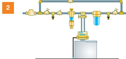
1 - Esquema de instalación filtro de seguridad con dosificador Cillit Immuno
